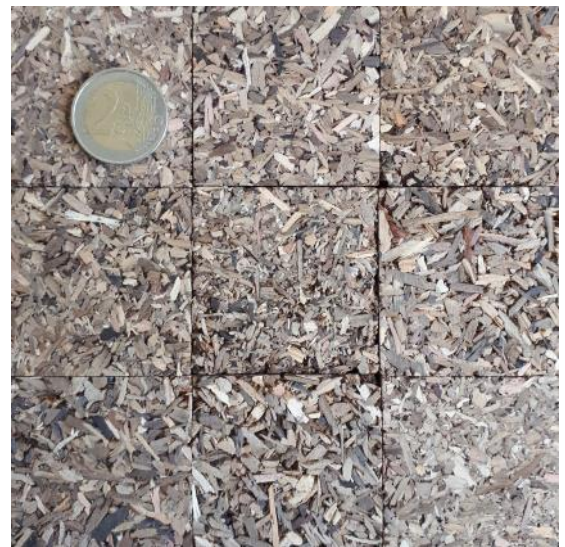
Abbildung 2: Spanplatten aus Kompost-Siebüberlauf (ohne Deckschicht).
